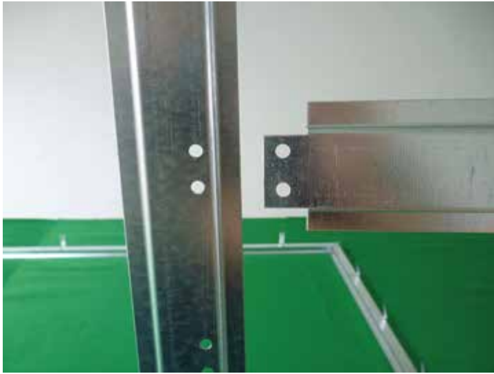
Montáž čelní příčky (pravé) k čelnímu pantovému sloupku (poz. 72 a 10)
