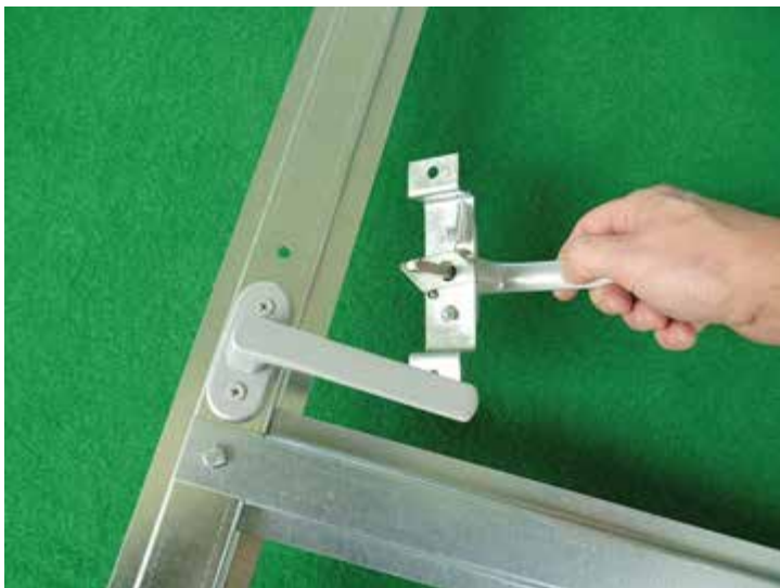
Montáž vnitřní části kliky
