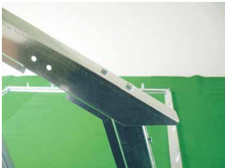
Montáž horního pravého rohového (střešního) sloupku (poz. 7, 9, 55 šrouby M6x25) Detailní pohled.
