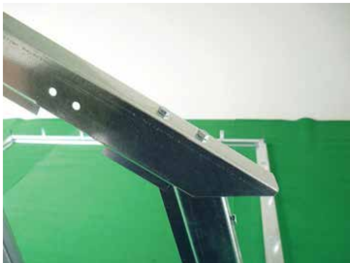
Spojení pozic 7, 9, 55 pomocí šroubů M6x25 a M6x10
