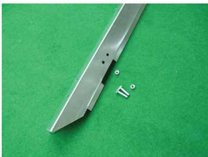
Spojení pozic 6, 8, 55 pomocí šroubů M6x25
